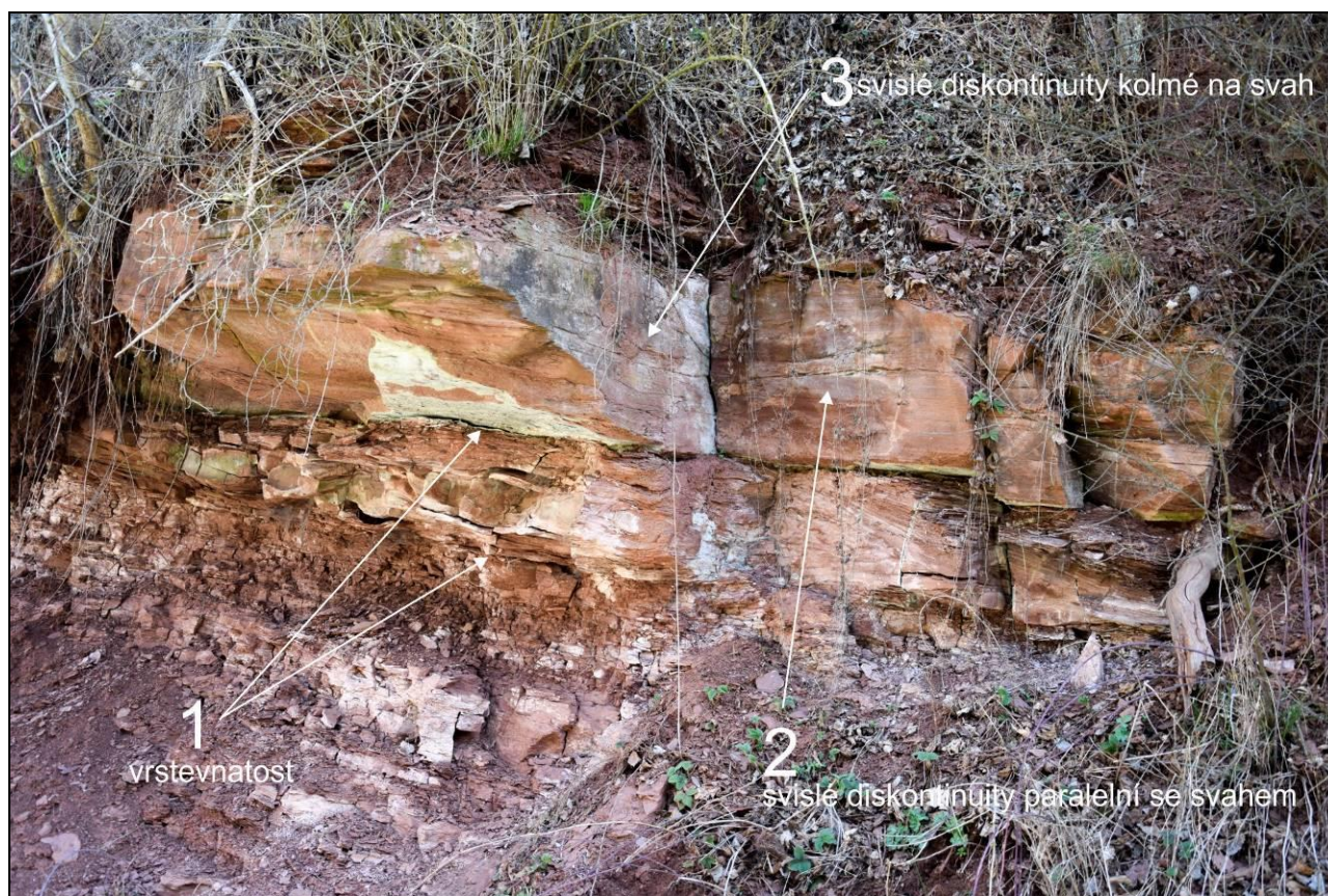
Foto 4 Vyznačení hlavních systémů diskontinuit – mírně k jihu ukloněná vrstevnatost a dva na sebe přibližně kolmé subvertikální systémy diskontinuit. Nestabilní převis tvořený lavicí pískovců vyčnívá ze stěny 1,4 m (měřeno od diskontinuity systému 2), v jeho podloží jsou patrné méně pevné a hustě diskontinuitami porušené prachovce (charakter prachovců – viz následující fotografie).
